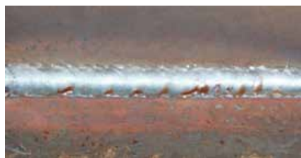
Рис 9.2. Сварной шов при максимальном значении индуктивности.
