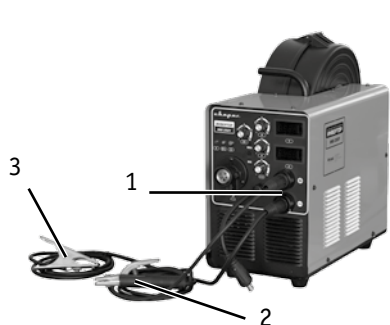
Рис. 6. Схема подключения оборудования для ММА сварки.
